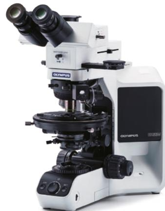
Коноскопическая/ортоскопическая конфигурация BX53M
